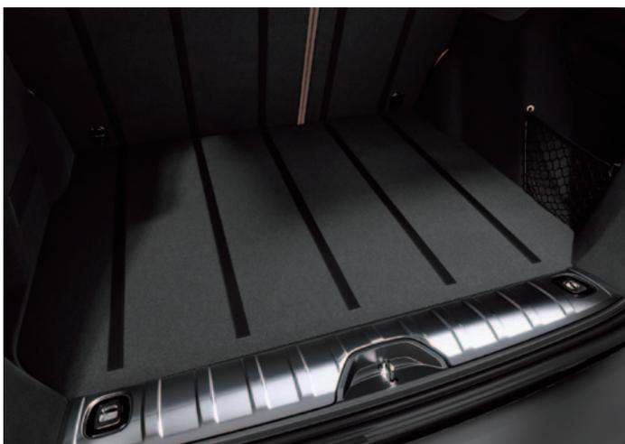
トランクの開口部にはステンレススチール製のシルガードが装着されており、ラゲッジスペースに設けられたレールとともに、荷物の出し入れを容易にします。同時に、このガードは傷を防止する役目も担っています。両端にはフックが装着され、ネットやストラップなどを使えば様々な形の荷物を保持することが可能になります。
