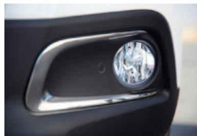
ブジョー2008の精悍なマスクにSUVらしい力強さを与えてくれるフロントフォグランプには、コーナーリング機能が装備されており、夜間や雨天時の視界確保に高い効果を発揮します。ステアリングの角度やウインカー操作に応じて、コーナー内側のランプが点灯し、視認性を向上させています。この機能は40km/h以下の速度で作動し、高めの着座位置で視界のよい2008の安全性をさらに充実させます。
