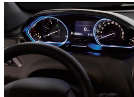
コクピットは、プジョー208と同様に小径ステアリングとヘッドアップインストールメントパネルを装備しています。メーター類は青のLEDライトで縁取られており、左にエンジン回転計、右に速度計が配されています。センター部分はインフォメーションディスプレイになっており、速度表示の他にも様々な情報をドライバーに与えてくれます。ドライバーの視線を大きく動かすことなく視認できるこのメーターと、小径ステアリングの操作性のよさはSUVの枠を大きく超えた利便性をドライバーにもたらしてくれることでしょう。
