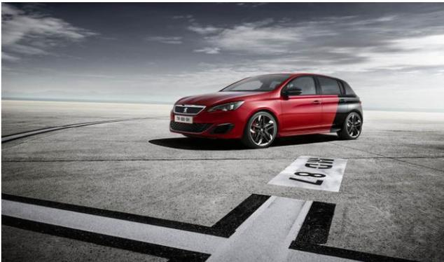
1.6ℓ THP 270 馬力のターボ付きガソリンエンジンを搭載しています。0-100km は 6 秒、電子制御によるトップスピードは時速 250km です。11mm 車高を低くし、トルセン LSD、大径 380mm フロントブレーキ、19 インチホイールにより、卓越したハンドリング性能を提供します。このモデルには 6 色に加え、ペルラ・ネラ・ブラックと新色アルティメイト・レッドのツートーンとなる、クーブ・フランシュを用意しています。
