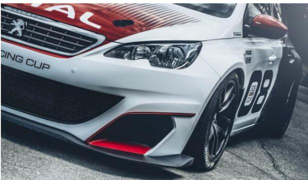
プジョー・スポールによる 308 GTi とエンジンの基本的な部分を共有しサーキットのために開発された 308、それが PEUGEOT 308 Racing Cup です。270 馬力を発生する 1.6ℓ THP ターボエンジンのモデルとは異なり、このモデルは 38 馬力多い 308 馬力を発生します。プジョー・スポールがチューニングを施す新しいレースカーは、パワーが 14%アップしており、スタンダードモデルよりも 100~150kg 軽量化されています。
