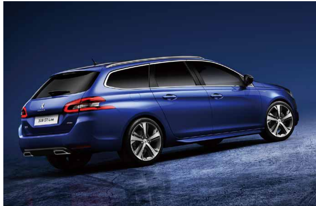
【308 SW GT Line】 1.2ℓ ターボチャージャー付き直列3気筒PureTechエンジン/6速オートマチックトランスミッション/最高出力:96kW(130ps)/5,500rpm/最大トルク:230Nm/1,750rpm/車両本体価格:¥3,388,000(消費税込)
