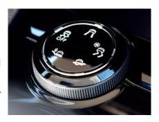
制御を行なう『アドバンストグリップコントロール』(5 モード。ヒルディセント機能含む)を搭載し、FWD ながら優れた悪路走破性を獲得しています。アドバンストグリップコントロール搭載モデルは、マッド&スノーのオールシーズンタイヤが装着されます。
