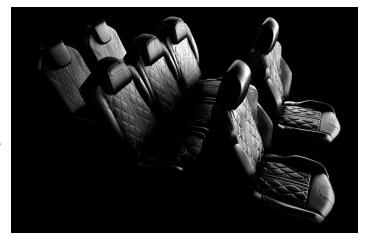
2列目シートは独立 3座でそれぞれ 15cm の前後スライドと 5段階のリクライニングが可能。荷室容量は 5名乗車時では 702  $\ell$  (VDA法) を実現しており、2列目シートを畳んだ 2名乗車では 1862  $\ell$  もの積載容量を得られます。またパセンジャーシートバックまでを倒すと、約 3.2m の長尺物を載せることさえで
